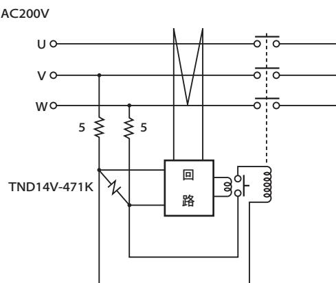
(5) 電磁ブレーキ開閉サージ吸収 (Magnetic Brake Surge Absorption)
