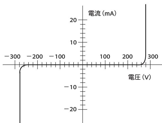
図1 バリスタの電圧-電流特性
