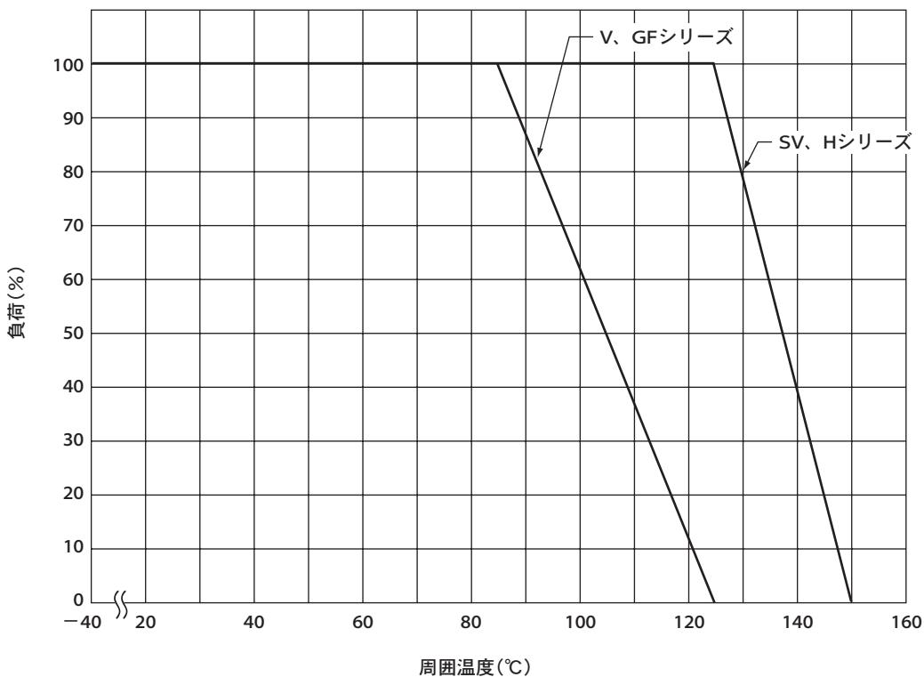
負荷としては、定格電力、最大許容回路電圧、サージ電流耐量（SVシリーズ：2回保証値）、エネルギー耐量が適用されます。例えば、TND10V-221K を 95°C 中で使用する場合は、負荷軽減曲線から負荷が 75% と読み取れますから下記のようになります。
