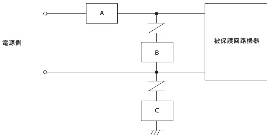
1) バリスタは、過電流保護装置A（ブレーカ、ヒューズ等）より回路側に取り付けて、バリスタの短絡時にすみやかに電源から切り放すようにして下さい。
