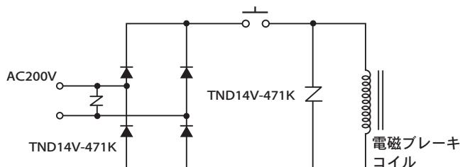
(6) 20kW 電動機制御回路 (Control of 20kW DC Motor)
