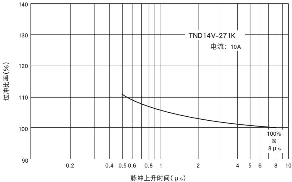
图5.浪涌上升时间与过冲比率的关系
