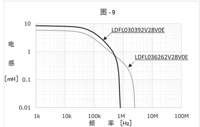
◆频率特性 环境温度：25℃（无风） 因DC电流通电产生的饱和温度
