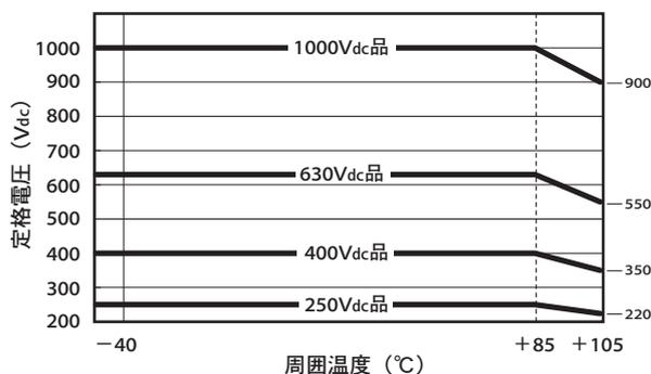
Fig.2 周囲温度に対する温度軽減電圧
