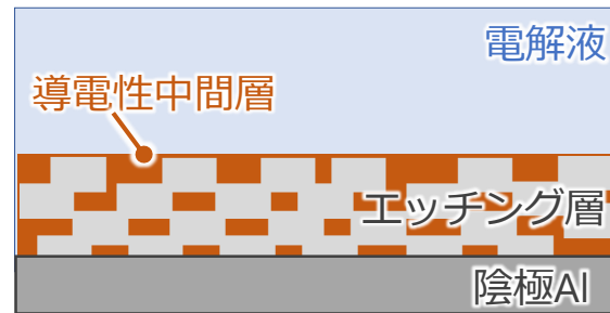
「導電性中間層」構造
