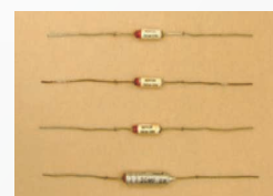
トランジスタラジオのファーストモデルに採用された、超小形電解コンデンサ(1955年製)
