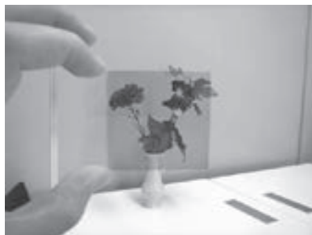
次世代型太陽電池等への応用が期待される透明電極
