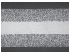
(交流エッチング箔の断面)
