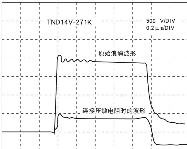
图6. 压敏电阻的浪涌吸收特性(布线长度5mm)
