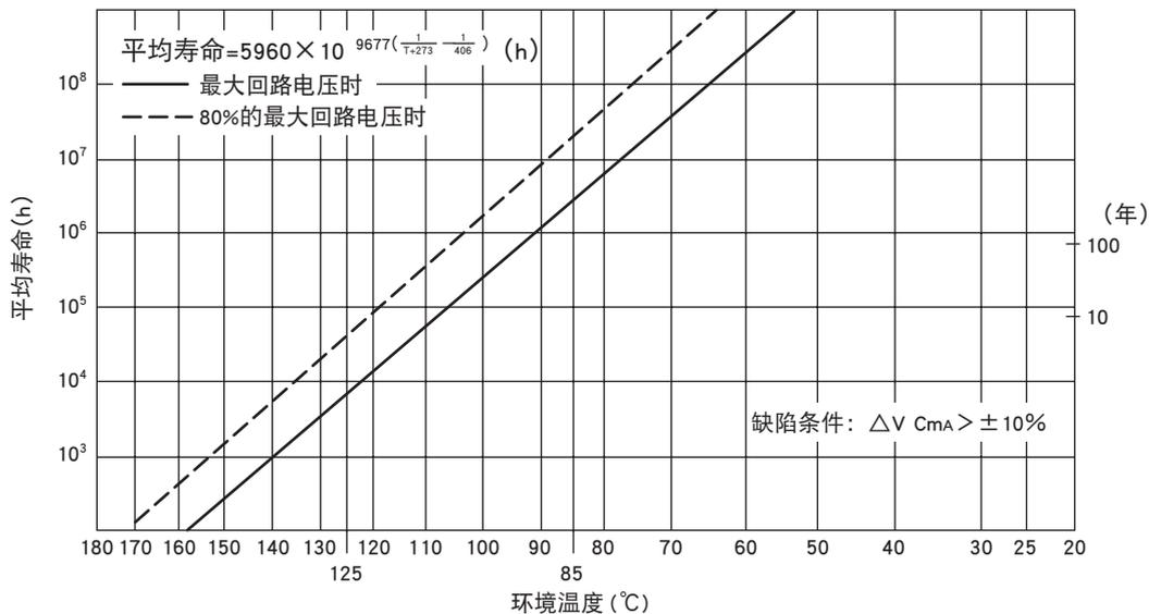
图4. 压敏电阻的平均寿命与环境温度的关系（无浪涌施加给压敏电阻时）
