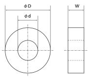
Outer diameter :  $\phi D$ Inner diameter :  $\phi d$ Width : W
