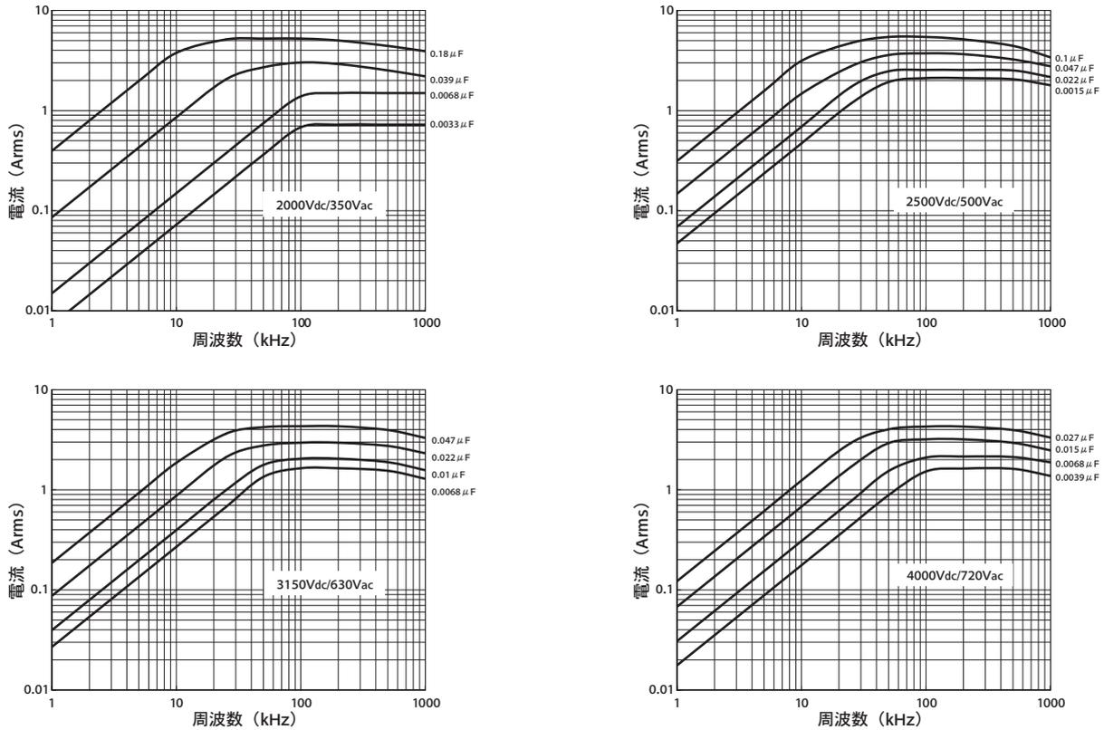
本資料は各定格電圧の代表的な容量値を選定して、周波数毎の電流カーブを作成しております。通常、静電容量が大きいほど流せる電流は大きくなりますが、構造違い（リードピッチ）により、静電容量が大きくなっても流せる電流が小さくなる場合があります。このため、本資料記載以外の製品をご検討される場合は、ご連絡くださるようお願いいたします。
