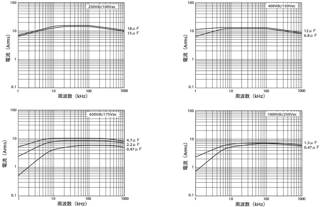
本資料は各定格電圧の代表的な容量値を選定して、周波数毎の電流カーブを作成しております。通常、静電容量が大きいほど流せる電流は大きくなりますが、構造違い（リードピッチ）により、静電容量が大きくなっても流せる電流が小さくなる場合があります。このため、本資料記載以外の製品をご検討される場合は、ご連絡くださるようお願いいたします。
