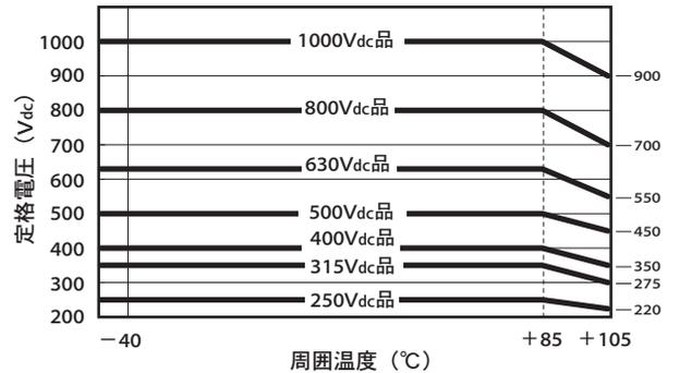
Fig.4 周囲温度に対する温度軽減電圧
