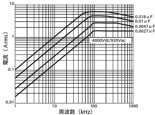
本資料は各定格電圧の代表的な容量値を選定して、周波数毎の電流カーブを作成しております。通常、静電容量が大きいほど流せる電流は大きくなりますが、構造違い（リードピッチ）により、静電容量が大きくなっても流せる電流が小さくなる場合があります。このため、本資料記載以外の製品をご検討される場合は、ご連絡くださるようお願いいたします。
