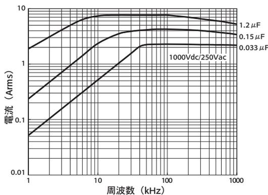
本資料は各定格電圧の代表的な容量値を選定して、周波数毎の電流カーブを作成しております。通常、静電容量が大きいほど流せる電流は大きくなりますが、構造違い（リードピッチ）により、静電容量が大きくなって流せる電流が小さくなる場合があります。このため、本資料記載以外の製品をご検討される場合は、ご連絡くださるようお願いいたします。
