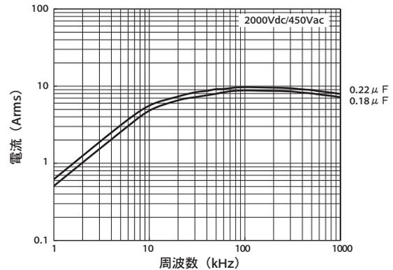
本資料は各定格電圧の代表的な容量値を選定して、周波数毎の電流カーブを作成しております。通常、静電容量が大きいくほど流せる電流は大きくなりますが、構造違い（リードピッチ）により、静電容量が大きくなっても流せる電流が小さくなる場合があります。このため、本資料記載以外の製品をご検討される場合は、ご連絡くださるようお願いいたします。
