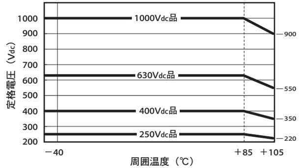
Fig.2 周囲温度に対する温度軽減電圧
