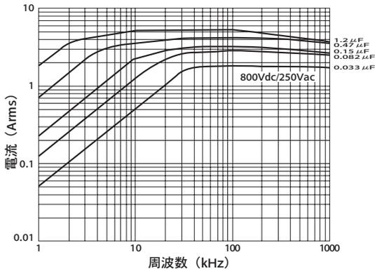
本資料は各定格電圧の代表的な容量値を選定して、周波数毎の電流カーブを作成しております。通常、静電容量が大きいほど流せる電流は大きくなりますが、構造違い（リードピッチ）により、静電容量が大きくなっても流せる電流が小さくなる場合があります。このため、本資料記載以外の製品をご検討される場合は、ご連絡くださるようお願いいたします。
