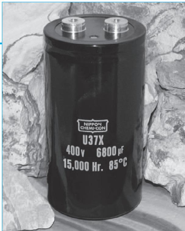
U37Xシリーズは、U37系シリーズの中で最も長寿命な製品です。高リプル化、長寿命化に対応し、インバータ用途向けに最適なシリーズです。U37Xシリーズの耐久性は、85℃15,000時間（リプル重畳）です。コンデンサ周囲温度が40℃以下、実使用リプル電流が定格リプル電流の2.1倍以下であれば、ユースフルライフは、最長175,000時間になります。このシリーズは、高電流対応のインチネジやミリネジなど様々な端子に対応しています。取付方法により、3点固定バンドやスタッドマウント形にも対応しています。個別仕様についてはお問い合わせ下さい。
