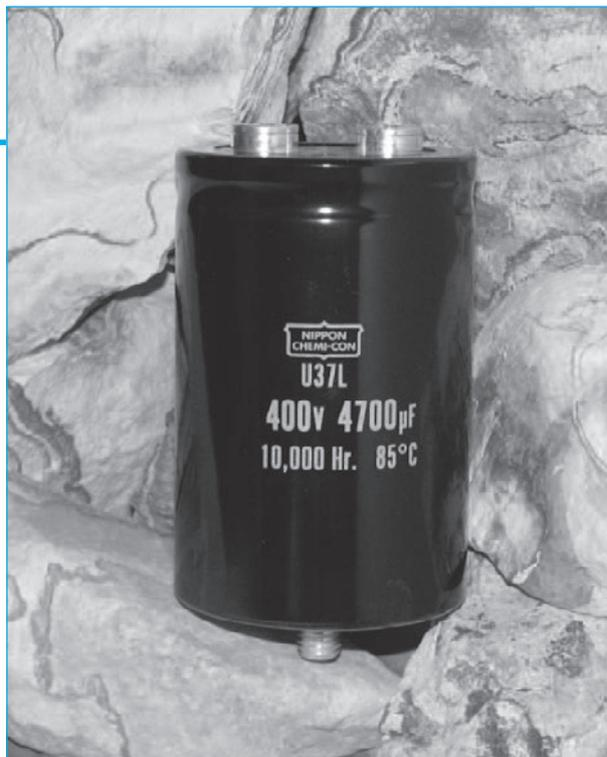
U37Lシリーズは、U37系シリーズの長寿命品で、高リップ化、長寿命化に対応し、インバータ用途向けに最適なシリーズです。U37Lシリーズの耐久性は、85℃10,000時間（リップ重畳）です。コンデンサ周囲温度が40℃以下、実使用リップ電流が定格リップ電流の2倍以下であれば、ユースフルライフは、最長175,000時間になります。このシリーズは、高電流対応のインチネジやミリネジなど様々な端子に対応しています。取付方法により、3点固定バンドやスタッドマウント形にも対応しています。個別仕様についてはお問い合わせ下さい。
