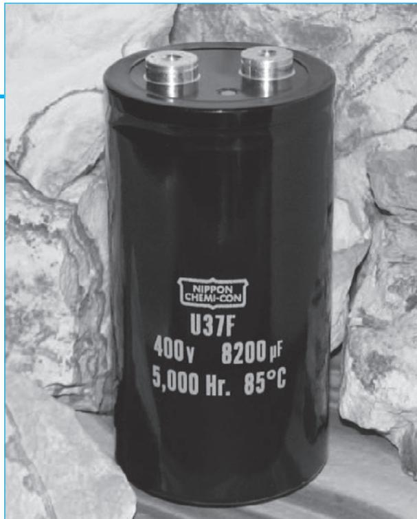
U37Fシリーズは、汎用向けネジ端子形アルミ電解コンデンサです。U37系シリーズは、高リップ化、長寿命化に対応し、インバータ用途向けに最適なシリーズです。U37Fシリーズの耐久性は、85℃5,000時間(リップ重畳)です。コンデンサ周囲温度が40℃以下、実使用リップ電流が定格リップ電流の1.5倍以下であれば、ユースフルライフは、最長150,000時間になります。このシリーズは、高電流対応のインチネジやミリネジなど様々な端子に対応しています。取付方法により、3点固定バンドやスタッドマウント形にも対応しています。個別仕様についてはお問い合わせ下さい。
