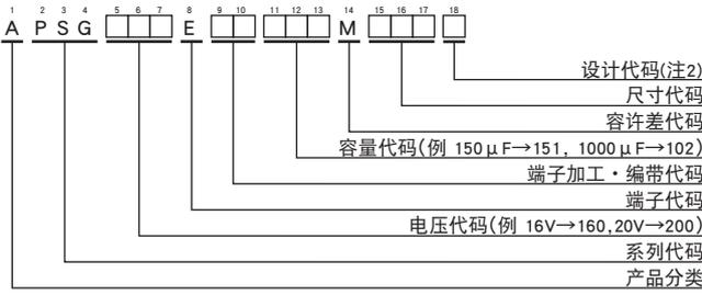
(注2) PSG系列的以下6个规格的设计代码为「J」, 但引线镀层规格和PSG系列的其他规格产品相同。
