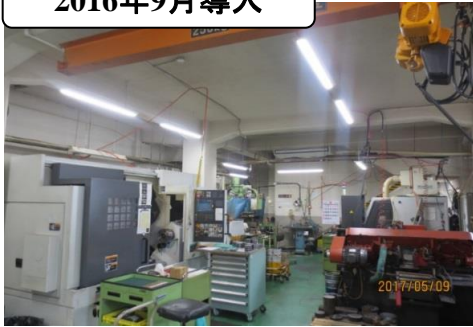
水銀灯からLEDへ効率蛍光灯等へ更新 (CO2、電力量削減)
