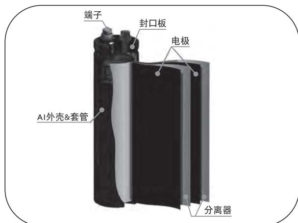
【图2】 DLCAP™ 的结构
