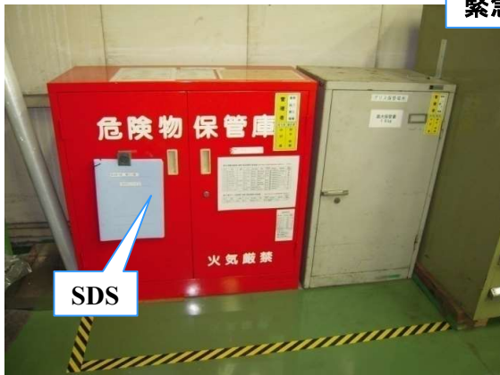
危険物保管庫による薬品管理
